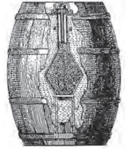
▲ Огнетушащая бочка Захарии Грейла давала водяной взрыв в очаге возгорания
