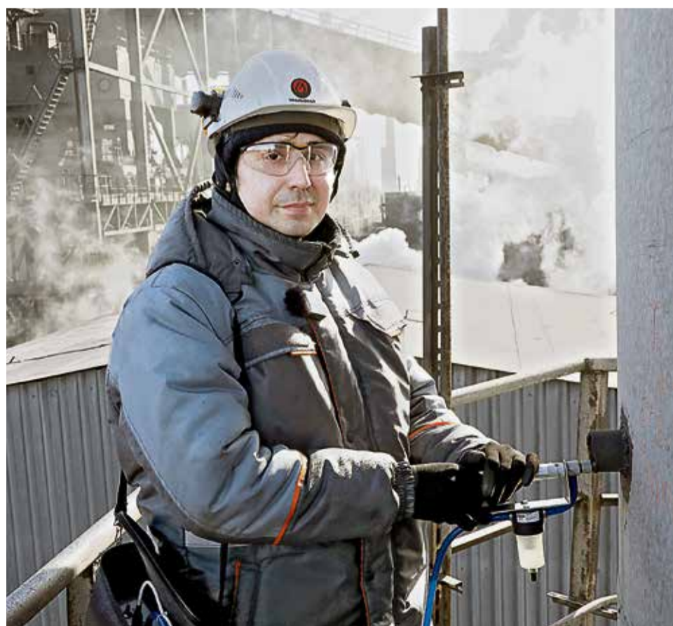
▲ Егор Зубарев берёт пробы газовой смеси на одном из объектов коксохимии. Потом его ждёт аглофабрика и так — пока не посетит все предусмотренные графиком ежедневных проверок точки
