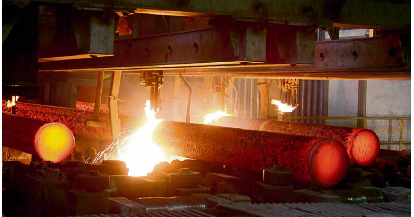
▲ Последняя стадия обработки круглой непрерывнолитой заготовки — порезка её на мерные длины. После остывания металл готов к погрузке в вагоны и отправке заказчику
