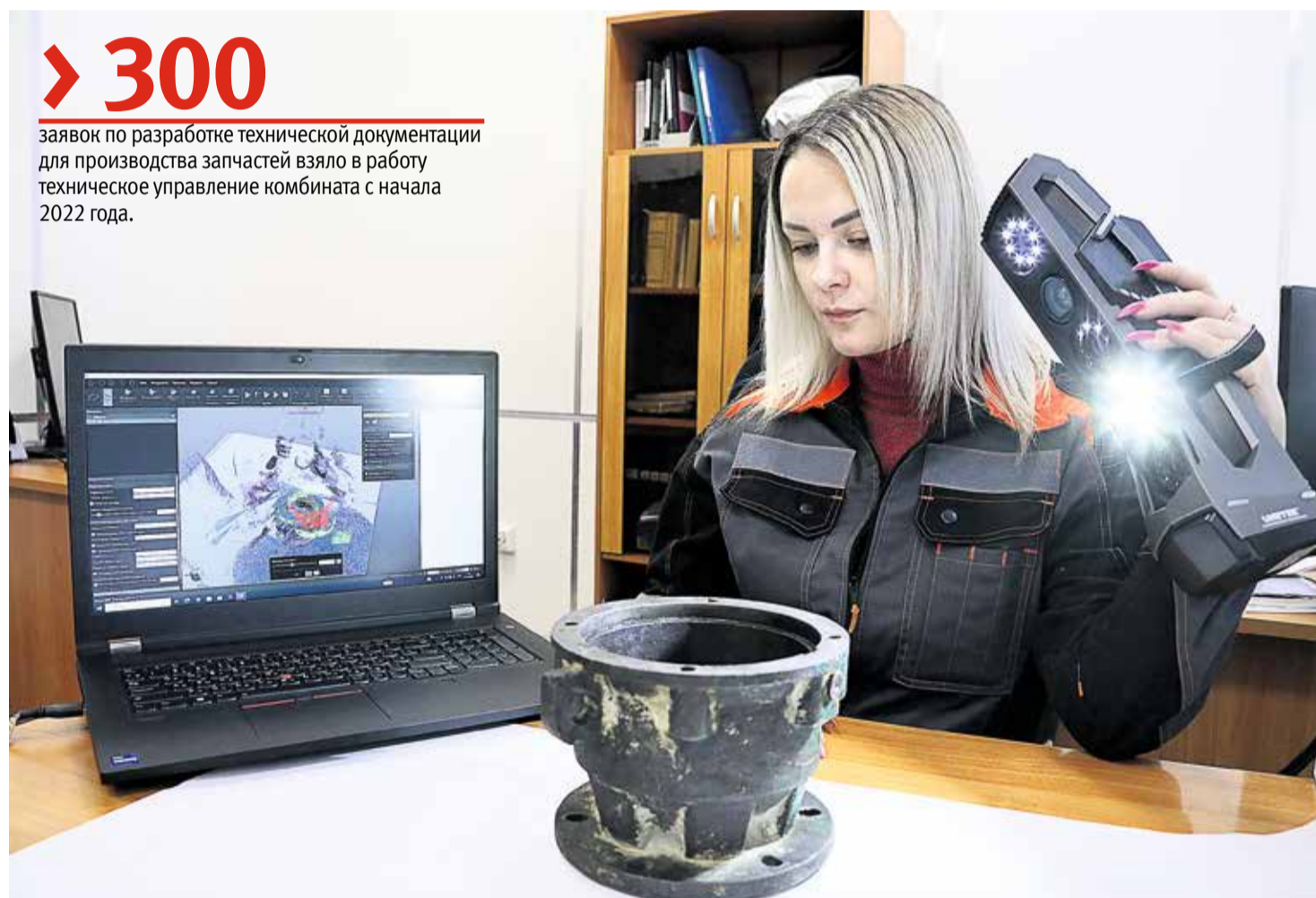
▲ Корпусу мотор-редуктора недолго гостить у конструкторов: закончив сканирование, Евгения Филиппова начнёт готовить на него рабочие чертежи
