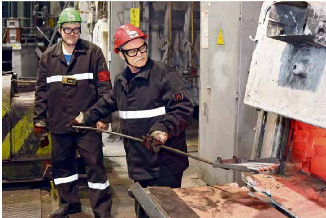
Мансур Абдрашитов и сегодня учит молодёжь: будущий термист Павел Фролов перенимает опыт закалки долот для отбойных молотков
