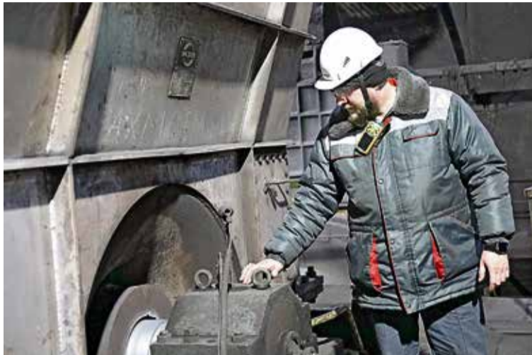
▲ На опорах валов агломаши уже несколько лет стоят датчики. Они собирают данные о температуре и вибрациях, чтобы тут же вывести их на дисплеи технологов
