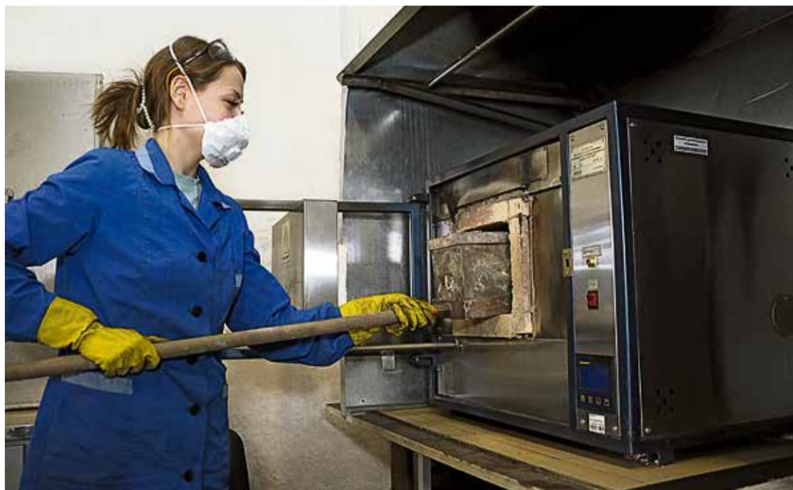
▲ Начальный этап испытаний: лаборант Анастасия Черенкова разогревает уголь в муфельной печи для вычисления его механической прочности
