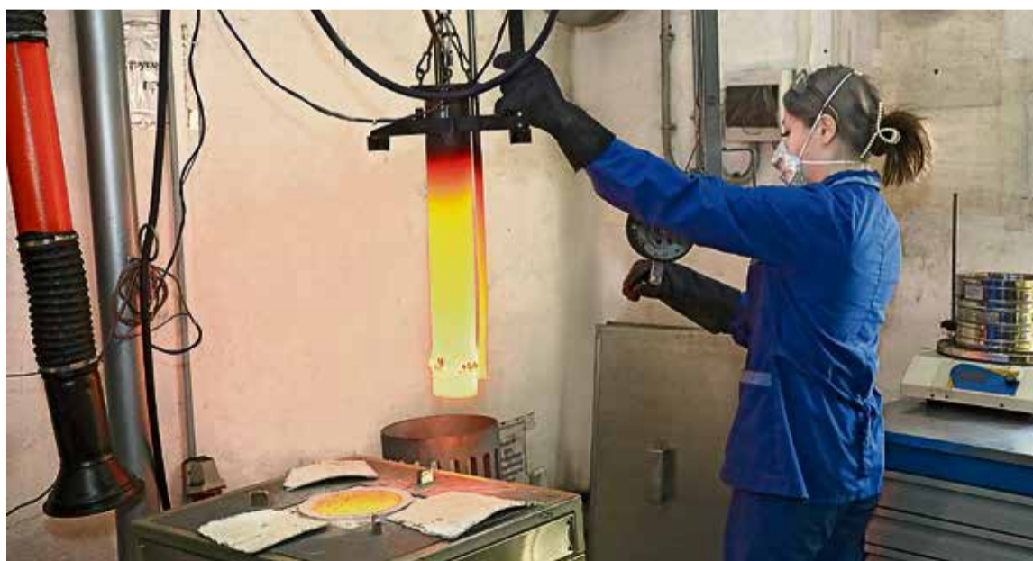
▲ Ещё один этап испытаний откроет исследователям реакционную способность образца и величину горячей прочности кокса
