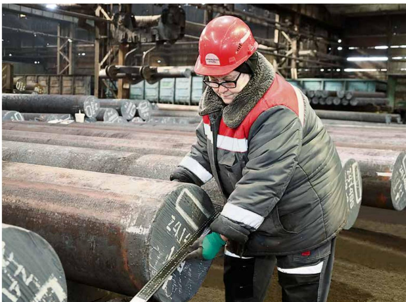
▲ Перед погрузкой контролёр УТК ЭСПЦ Светлана Арефьева проверяет каждую заготовку на соответствие геометрическим параметрам и отсутствие дефектов
