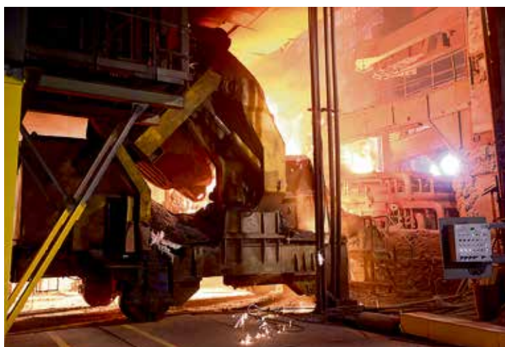
◀ Осенью одна из гибких модульных печей ЭСПЦ целый месяц отработала с... отключёнными электродами, в режиме кислородного конвертера. Решено тиражировать этот эксперимент
