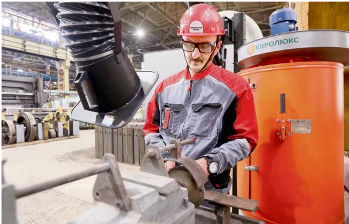
▲ Новые аспирационные установки не требуют много места и просты в обслуживании
