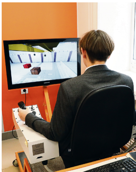
▲ Джойстик как в компьютерной игре, а вот задача — иная: аккуратно переместить в нужную точку груз мостовым краном
