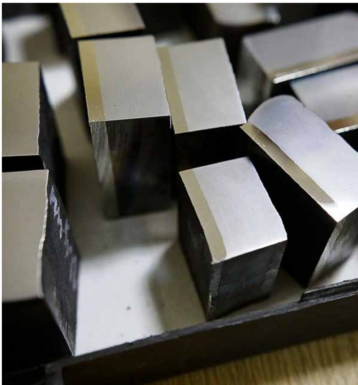
▲ Обычный глаз видит чёткую границу двух слоёв, и только под микроскопом понятно, что два металла очень глубоко по меркам микромира проникли друг в друга
