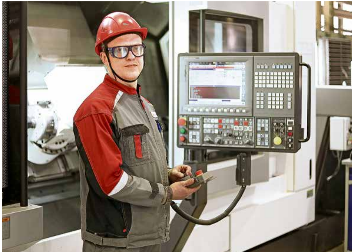
▲ За рабочими параметрами агрегата следит мощный компьютер. Условия обработки задаются на специальной панели, а некоторыми функциями можно управлять с выносного пульта
