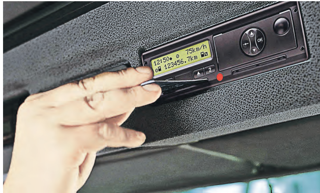
Запись маршрута и графика работы водителя ведется с помощью тахографа
