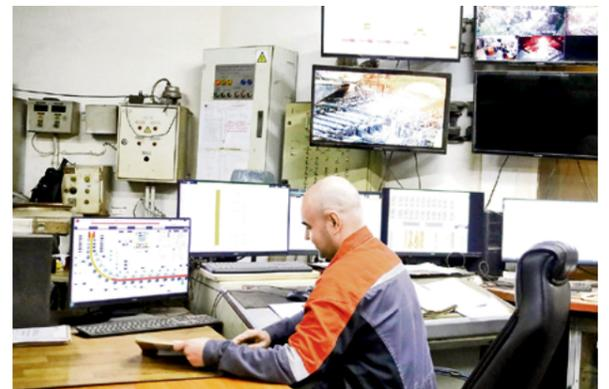
▲ Все фазы прохождения слитка до момента его формирования операторы МНЛЗ-2 отслеживают с помощью видеокамер и графических моделей
