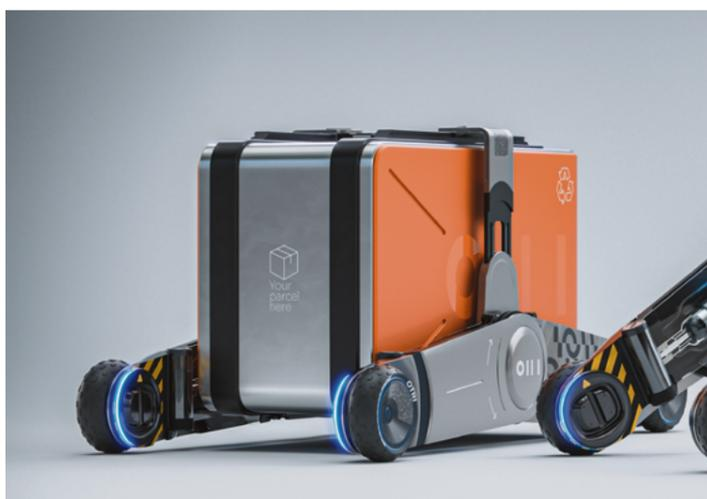
▲ Роботы, спроектированные в «2050.ЛАБ», могут перевозить грузы различных габаритов на одном унифицированном электрошасси
