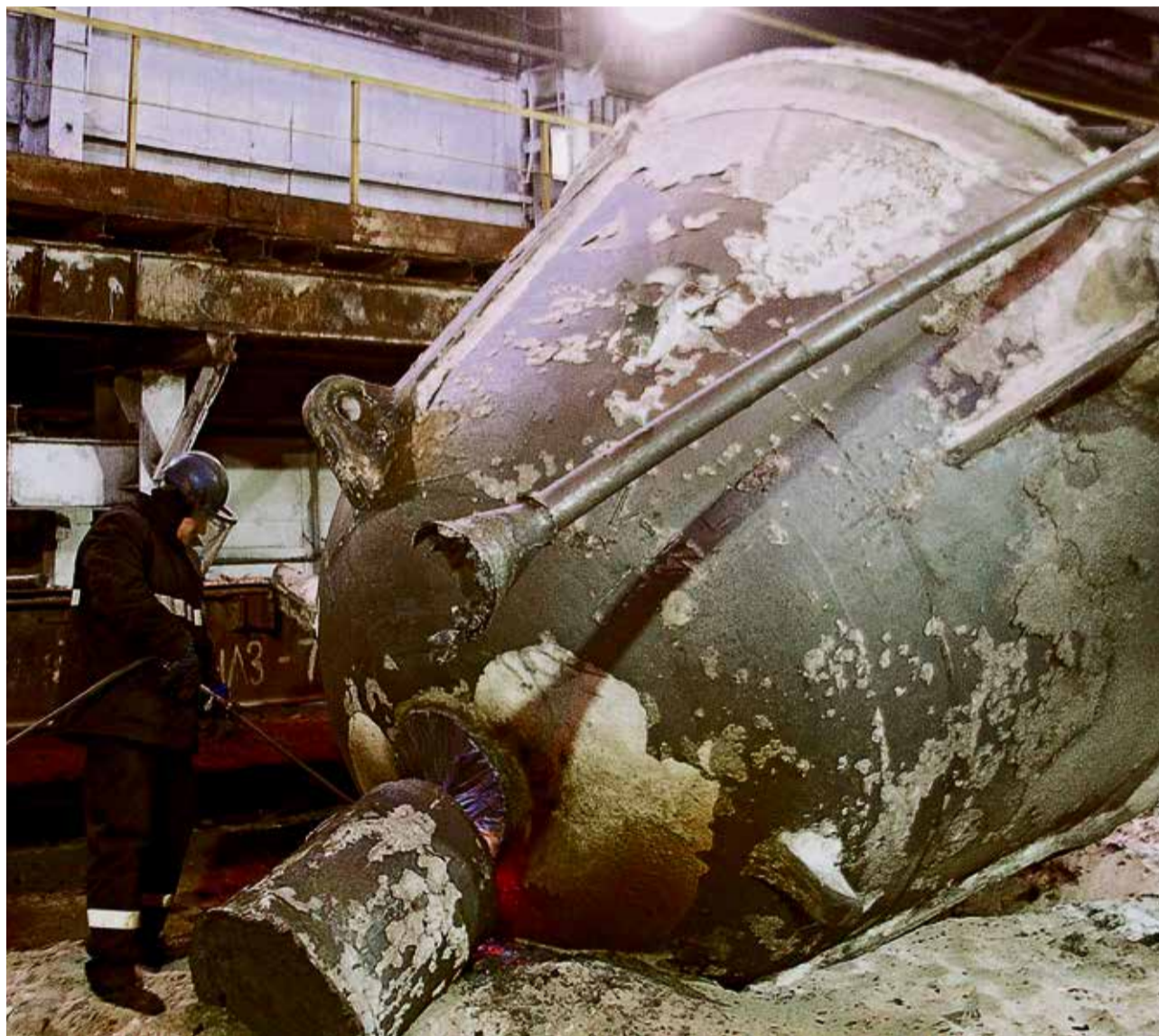
▲ Чаша должна выдерживать температуру налитого шлака в 1 200 градусов выше нуля по Цельсию, поэтому производится она из специально подобранной марки стали
