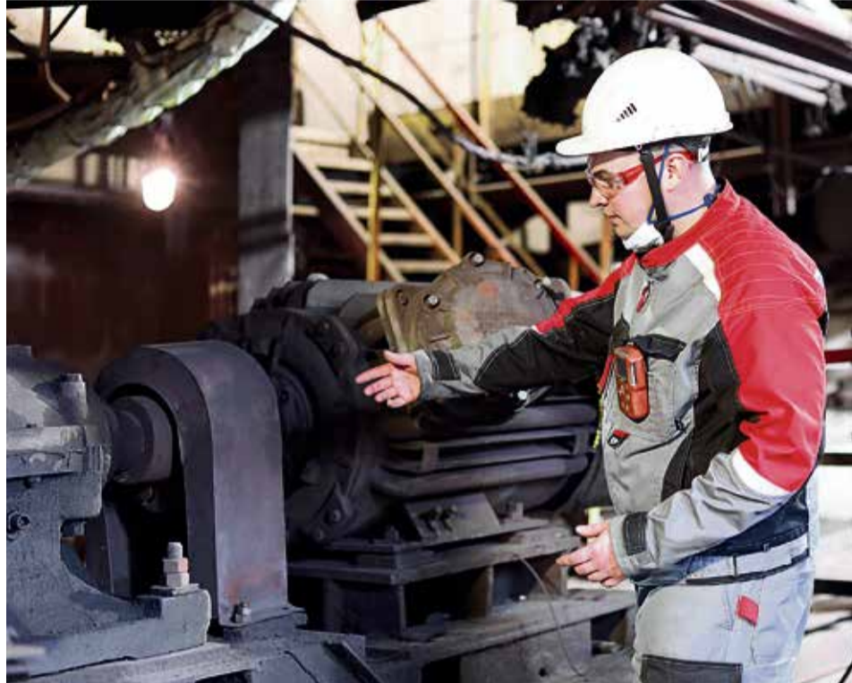
▲ «Только представьте: раньше мы снимали двигатель, потом съёмником — полумуфты. А теперь достаточно убрать защитный кожух — и узел готов к ремонту!» — рассказывает эксперт Бизнес-Системы Владимир Давыдов
