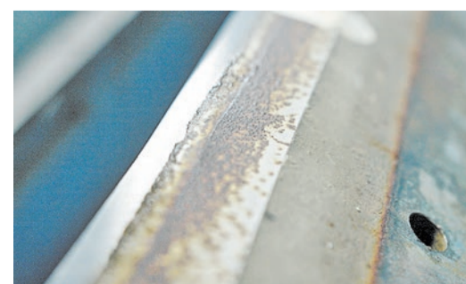
Десятки проходов по льду превращают нож в... пилу.
