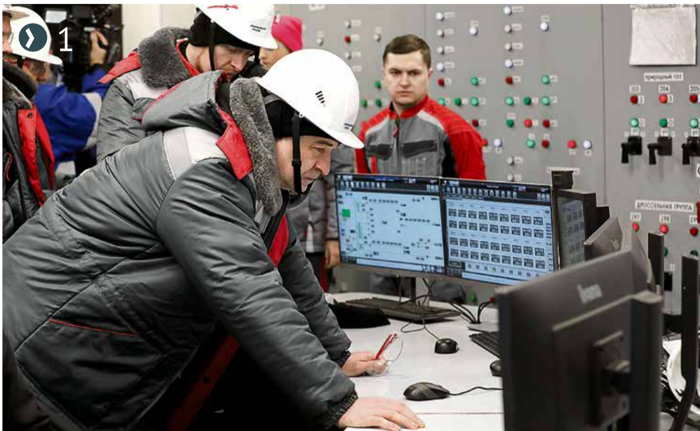
▲ Основным объектом внимания гостей стал пульт управления третьей печью с бесконусным загрузочным устройством
