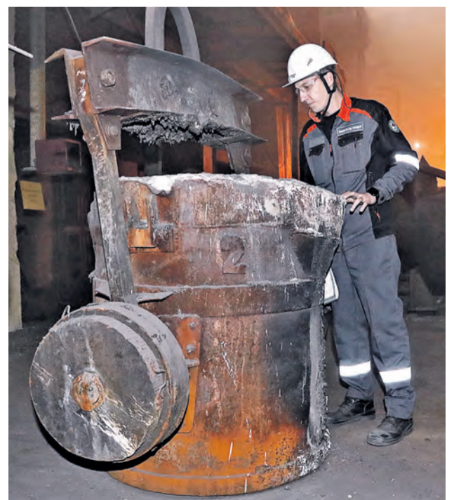
▲ Для небольшого объёма металла в ковше очень важно удерживать температуру, пригодную для разливки. Инженеры ФЛЦ решили эту задачу
