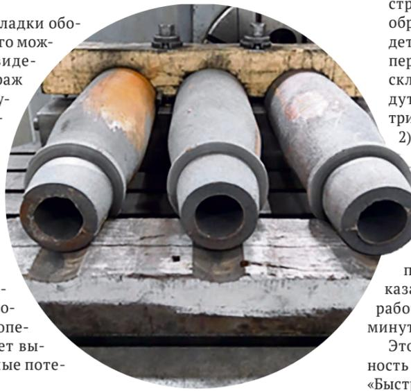
▲ Несложное приспособление позволяет обработать сразу три корпуса циклона за раз
