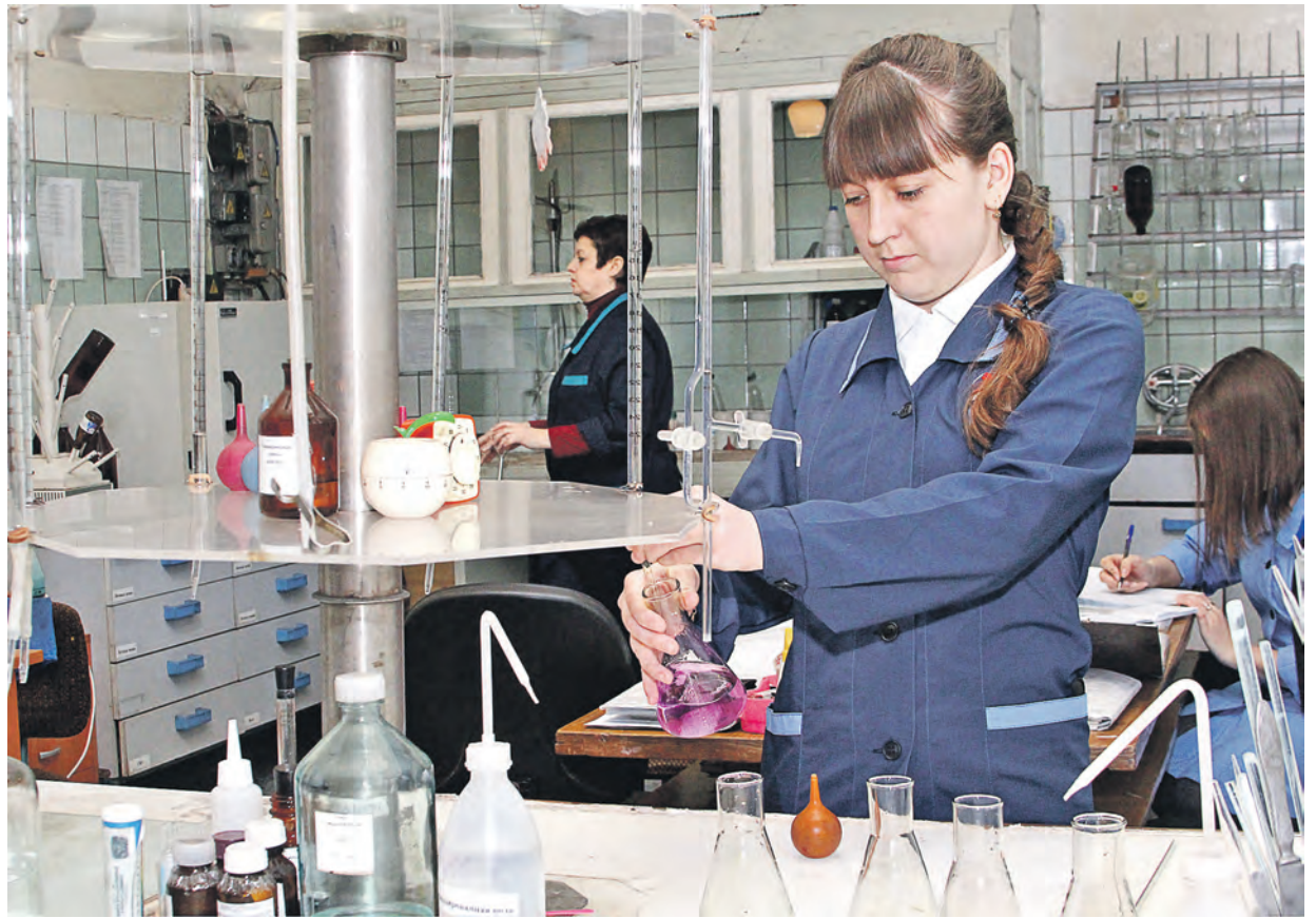
Сотрудник лаборатории охраны окружающей среды Наталья Доброконь ведет исследование воды на жесткость
