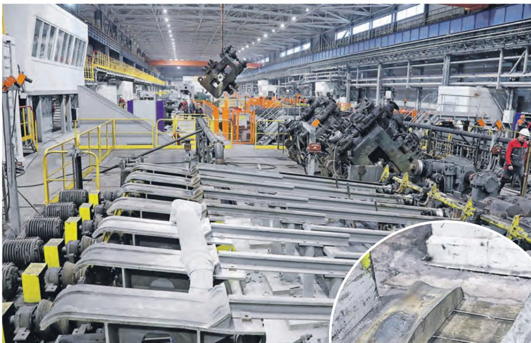
▲ Работа сложнейшего трубопрокатного стана невозможна без небольшой детали — направляющей линейки из металла особого сорта: бидулоидного сплава
