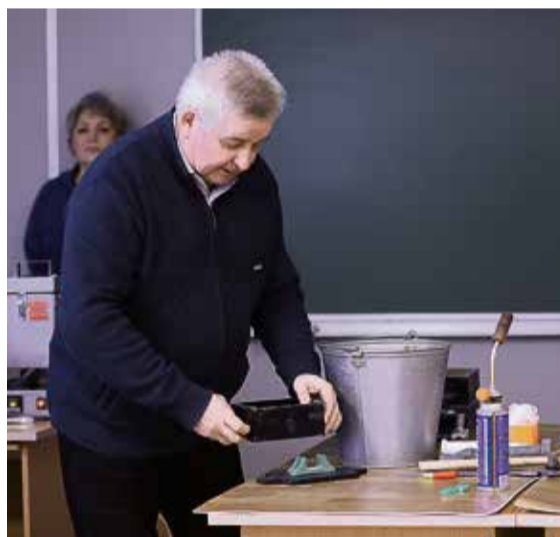
◀ Созданная 3D-модель сразу готова к отливке, нужно только упаковать её в формовочную смесь
