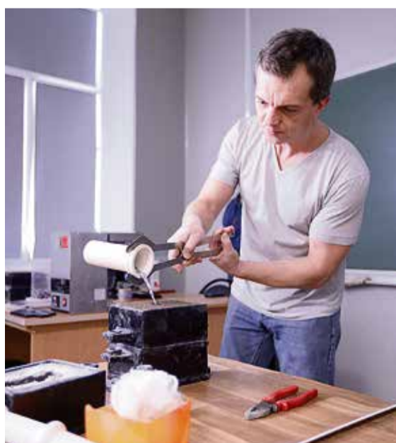
◀ Жидкому металлу нужно несколько секунд, чтобы проникнуть внутрь формы и заместить собой пластиковый образец
