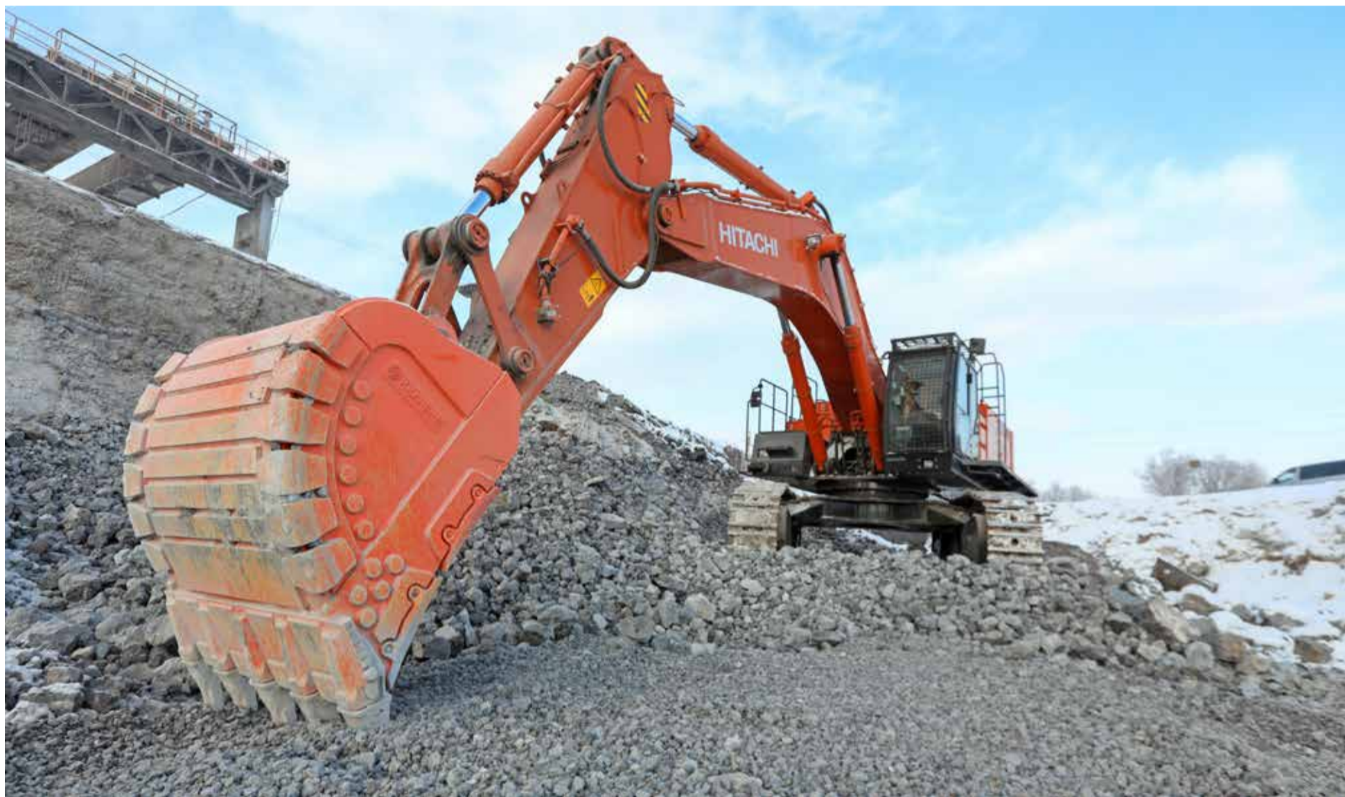
▲ Кузов КамАЗа-самосвала такой ковш заполняет за два подъёма, усиленный износостойкими накладками, он может работать с самыми твёрдыми материалами, а его замена в случае необходимости на другой инструмент не займёт много времени
