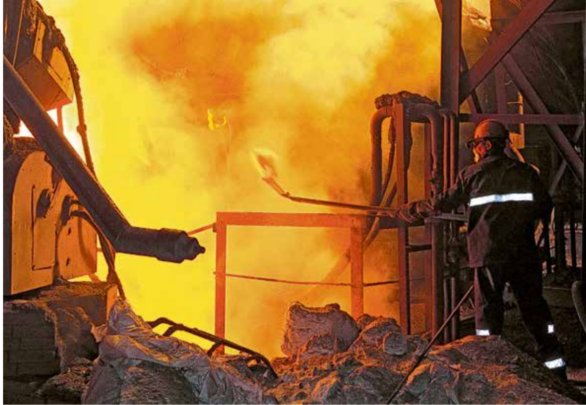
▲ Несколько взмахов лопаты — и подсолённый шлак перестает пениться, позволяя сталеварам не отвлекаться по мелочам
