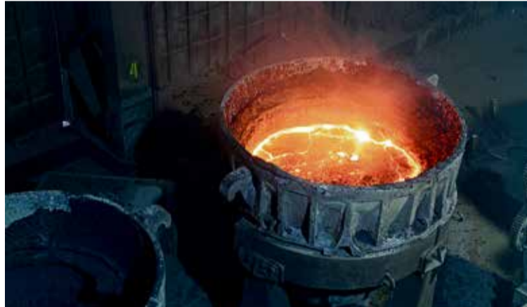
▲ Ёмкости одной шлаковой чаши теперь хватает на две плавки
