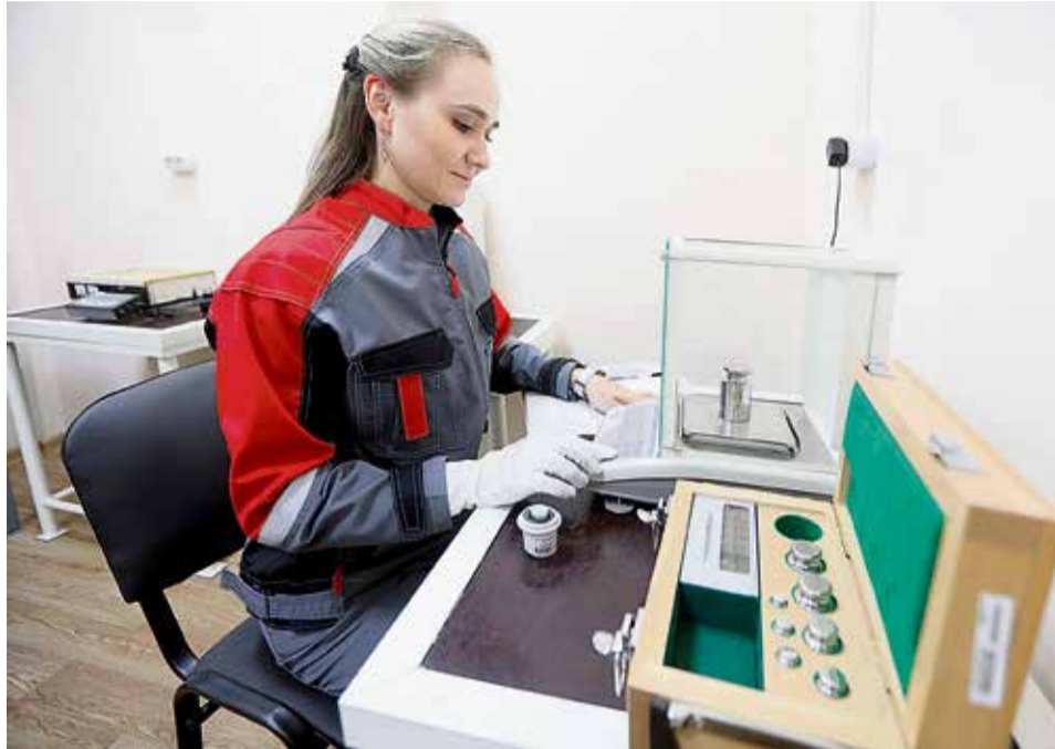
▲ Даже жир с рук, попав на контрольный груз, способен исказить результаты, поэтому поверку весов в ЦЛМ ведут в белых перчатках
