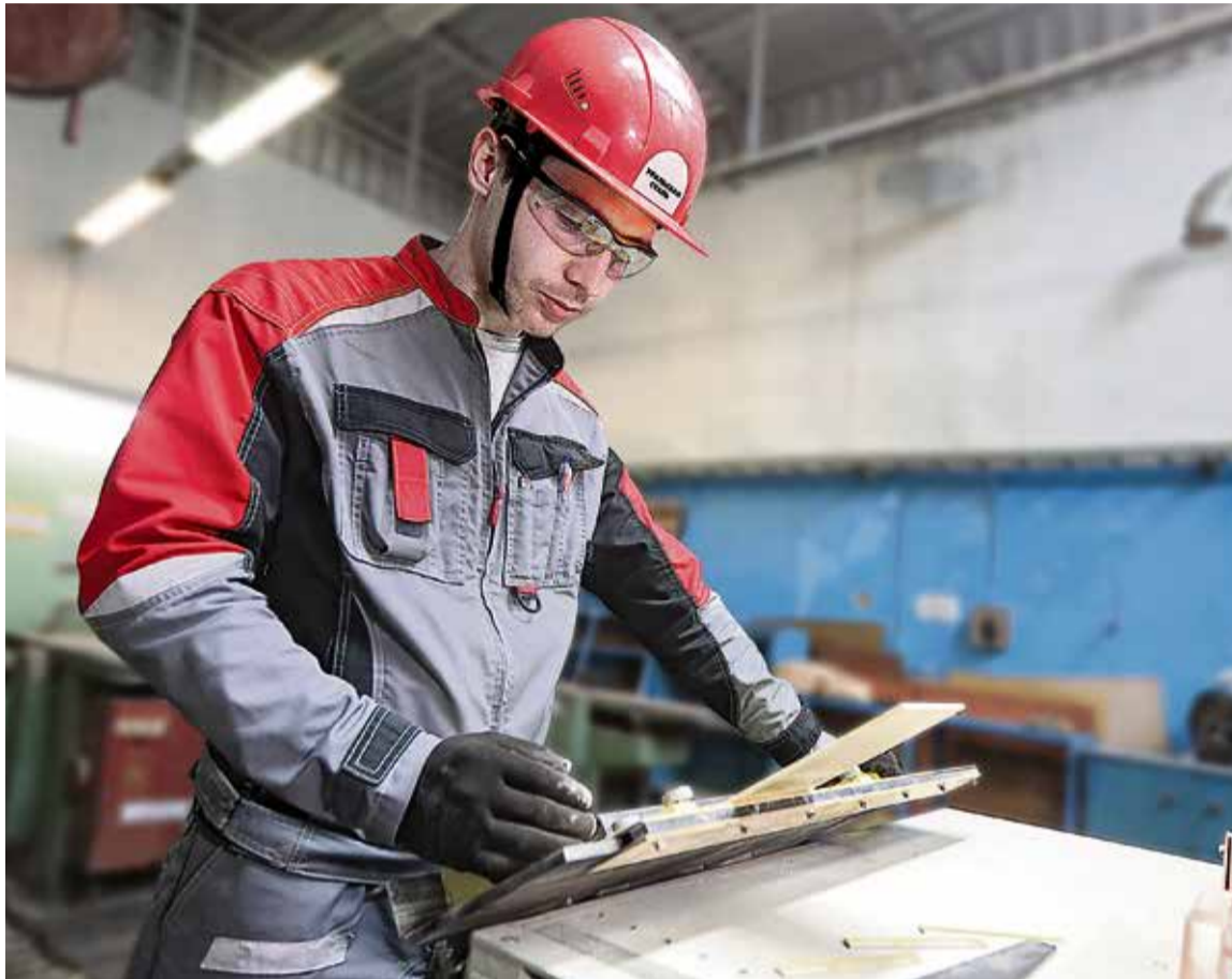
▲ Для Ивана Осипова в ремонте нет мелочей — вырезанный с точностью до градуса клин для электродвигателя не даст мотору выйти из строя раньше времени
