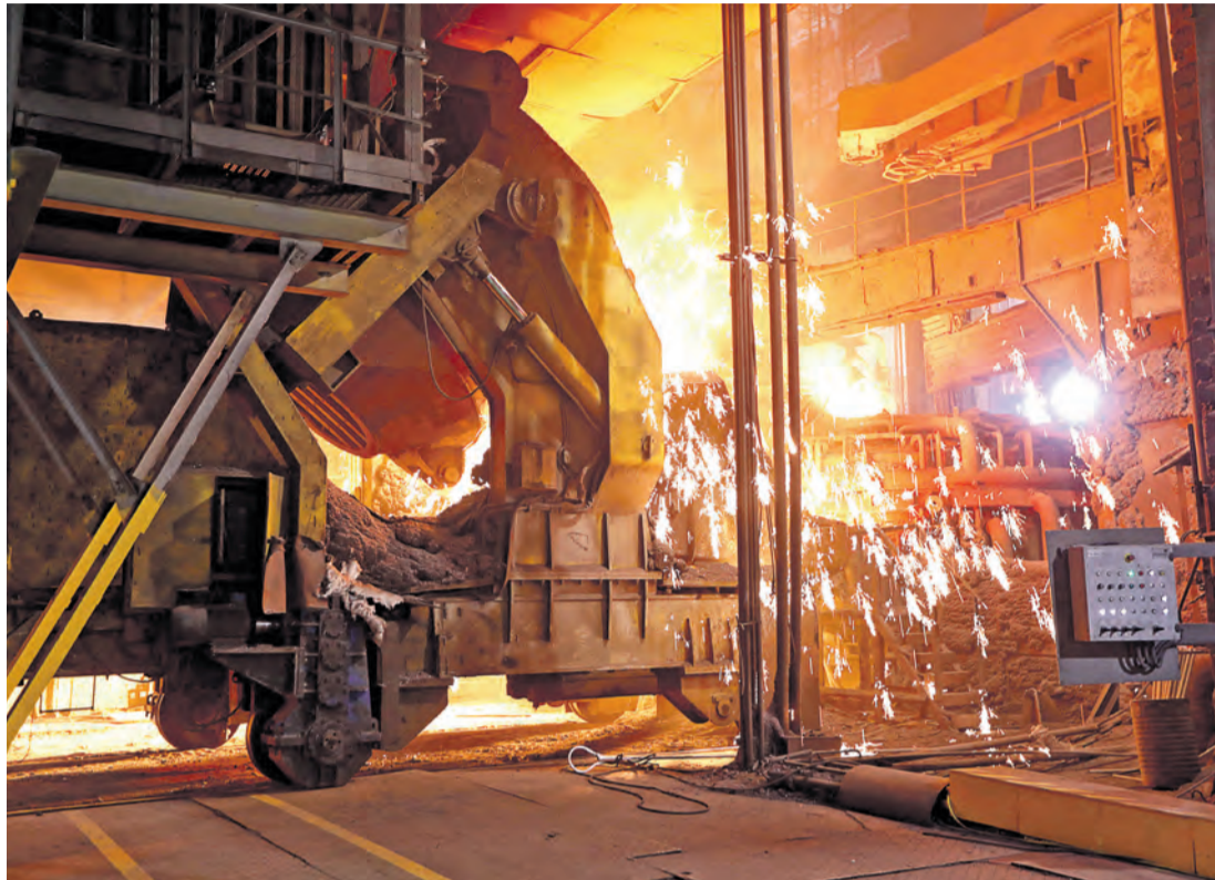
▲ Увеличение доли жидкого чугуна, который заливают в печь, оказалось эффективным методом снижения себестоимости готовой стали
